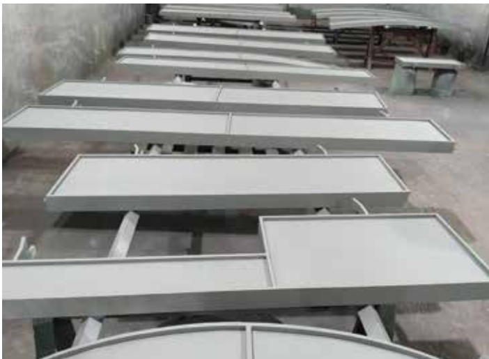
↑ Obra: Estruturas Metálicas // Localidade: S. Romão do Coronado // Produtos: Primário Epoxi Zinco EP 15-020, Esmalte Forja Cinza Alumínio // Cliente: Metalizareal - Tratamentos Anticorrosivos, Lda. // Comercial: Carlos Oliveira
