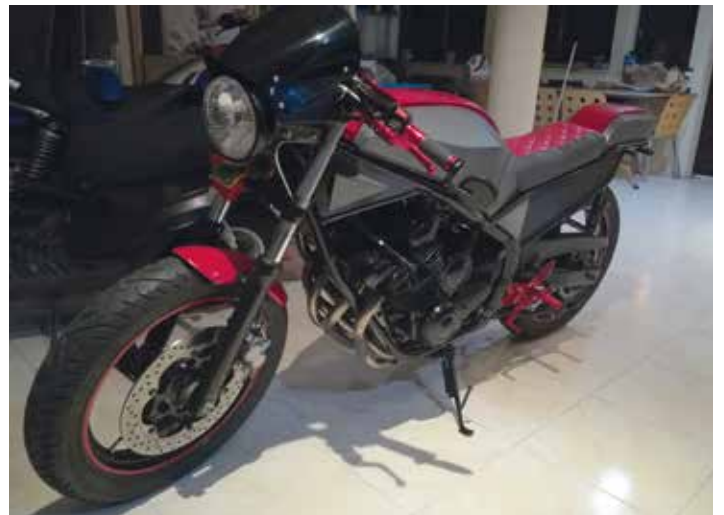
↑ Obra: Mota // Localidade: Lagoa - Mira // Produtos: Motor: Esmalte AT 250 | Quadro: Esmalte PU // Cliente: SMC Motos Custom // Comercial: Mário Melo
